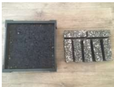
Сурет 2.5 - Асфальтбетон үлгілері: квадрат плитка формасындағы 305x305x50 мм өлшемімен (сол жақ); тік бұрышты призма формасындағы 50x50x150 мм өлшемімен (оң жақ)
