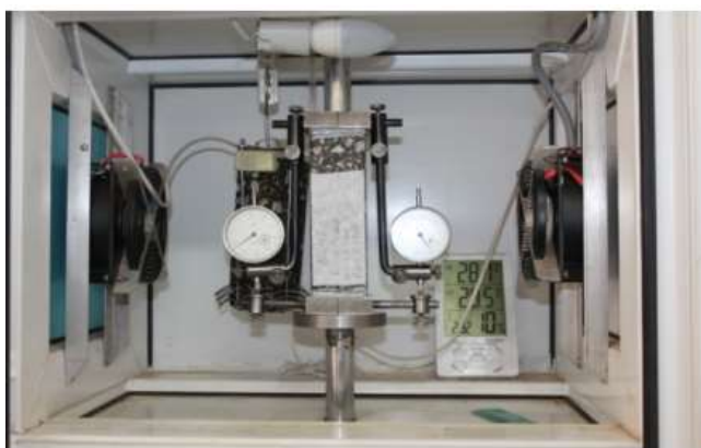
Сурет 2.8 - Сынаққа арналып орнатылған үлгі
